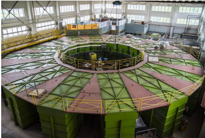
Рис. 1. Генератор тераваттного уровня мощности ГИТ-12, амплитуда тока 5 МА, время нарастания тока 2 мкс
