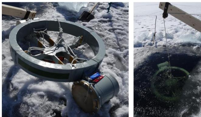
Спуск передатчика ближнепольной системы связи в прорубь на Красноярском водохранилище
